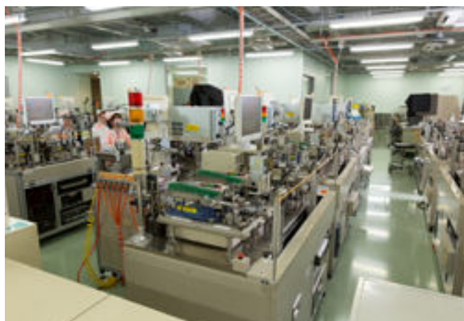
Assemblage des brackets automatisé Usine TOMY (Japon)
